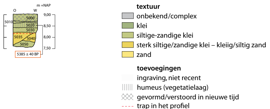
Figuur 3.6. Project Zv8. Deel van het getrapte zuidprofiel van put 2; zie figuur 2.7 voor positie. Schaal horizontaal 1:200, verticaal 1:100.
